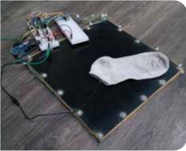
Prototype van de drukmat met geleidende sok.
