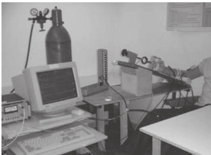
Foto 1: Voorbeeld van een opstelling voor een meting van zuurstofopname en doorbloeding.
