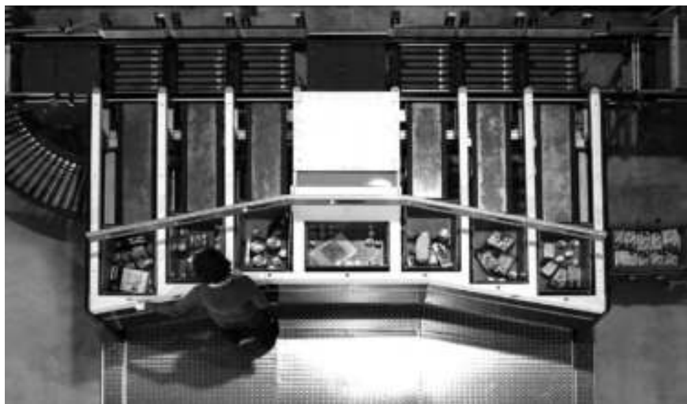
Cockpitopstelling bij orderverzamelen (Pick@Ease4, Vanderlande Industries) Bron: onderzoeksverslag van TNO van website TNO
